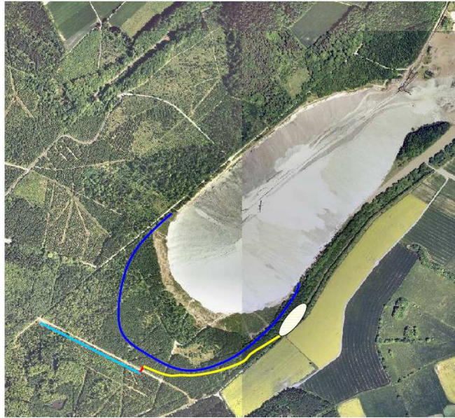
Abbildung 4-12: Schematische Darstellung der Haldenentwässerung
