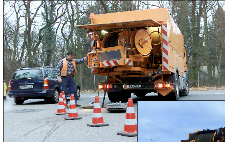
HD-Spül- und Saugfahrzeug mit Wasserrückgewinnung
