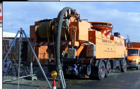
HD-Spül- und Saugfahrzeug mit Wasserrückgewinnung
