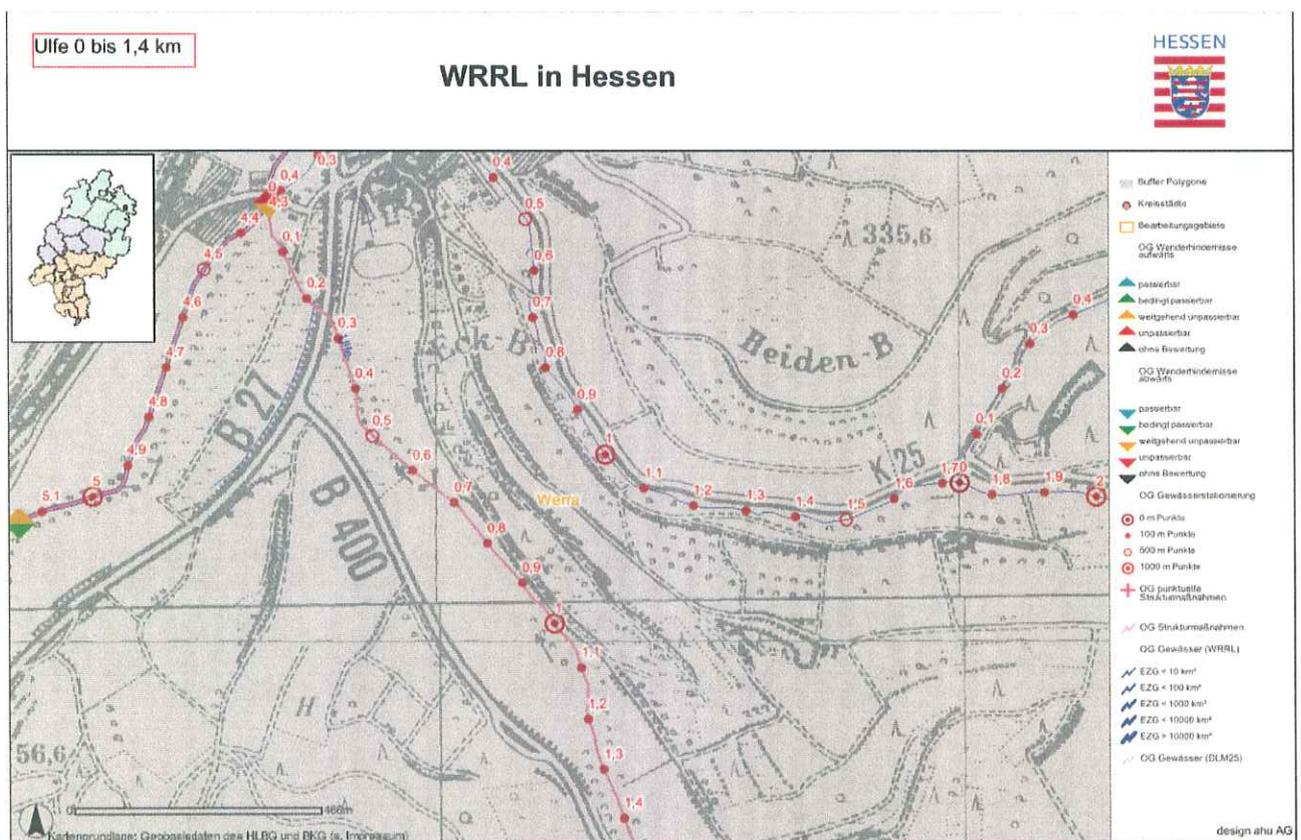
Abbildung 15: Ulfe, km 0,0 bis 1,4, Gewässerabschnitte mit Strukturmaßnahmen und Querbauwerken
