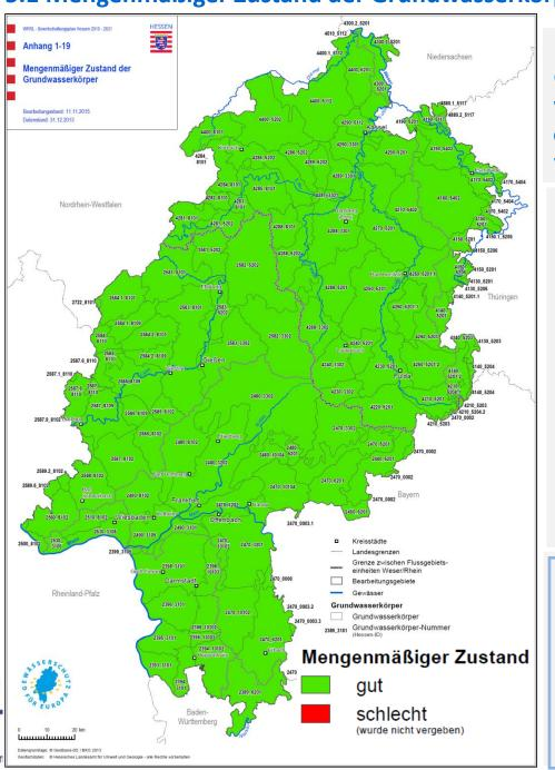
Die WRRL nennt den Grundwasserspiegel als den wesentlichen Parameter zur Beurteilung eines guten mengenmäßigen Zustands von Grundwasserkörpern.
